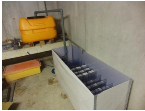
写真-2 乾湿繰返し試験器
