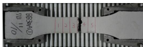
写真-4 ひび割れ発生状況例
