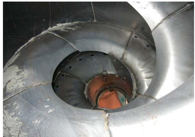
写真-5 フラッシング剤噴霧洗浄の運用6か月後のドラム内状況（左：ドラム底部，右：羽根の裏側）
