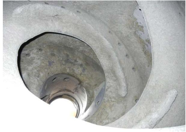
写真-4 従来手法（水洗浄）のドラム内状況（左：ドラム底部，右：羽根の裏側）
