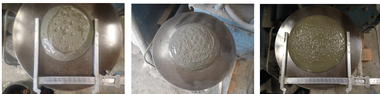
(a) 目標 FL=150 (6号, W/C=0.30, 設計 VR=15%) (b) 目標 FL=190 (6号, W/C=0.30, 設計 VR=25%) (c) 目標 FL=210 (7号, W/C=0.30, 設計 VR=25%)
