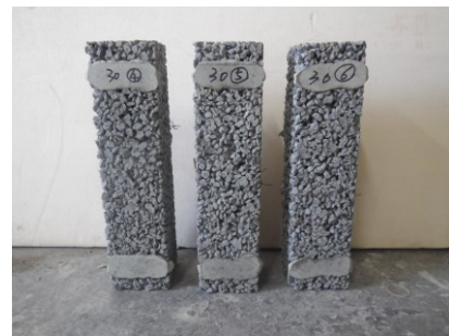
(b) 止水セメントで支点をキャッピングした角柱試験体
