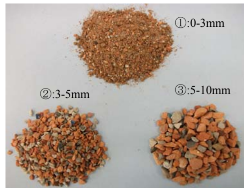
写真-1 試験に用いた廃瓦骨材
