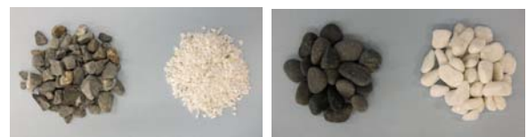
写真-2 砂利舗装供試体に用いた比較用の骨材 (左から, 碎石(黒), 碎石(白), 砂利(黒), 砂利(白))
