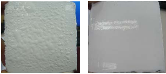
無塗布/EP Si/EP 複合保護層の構成
