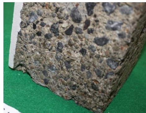
写真-5 半面被覆供試体 300サイクル後の様子
