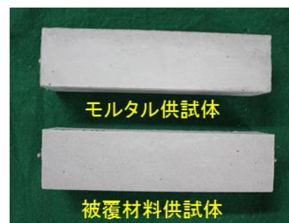
写真-2 供試体概要(乾燥収縮-被覆材料供試体)
