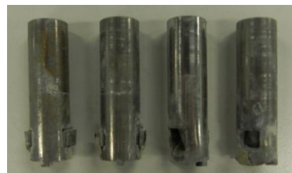
図-9 裏面に施工した新型アンカーの試験後の様子 (3da 4da 5da 6da)
