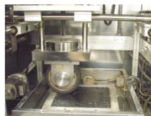
写真-1 水浸ホイールトラッキング試験機
