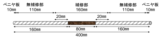
図-2 実験ケース II で用いた鉄筋
