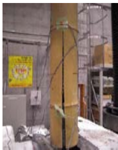
写真-1 引張試験時の割裂破壊
