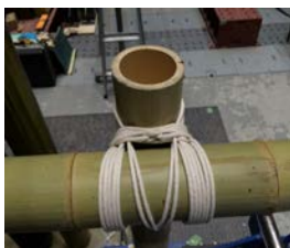
写真-3 ロープによる接合状況
