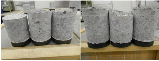
写真-1 付着試験体の破壊形状
