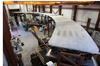
図-1 3 径間曲線橋梁モデルの震動台実験
