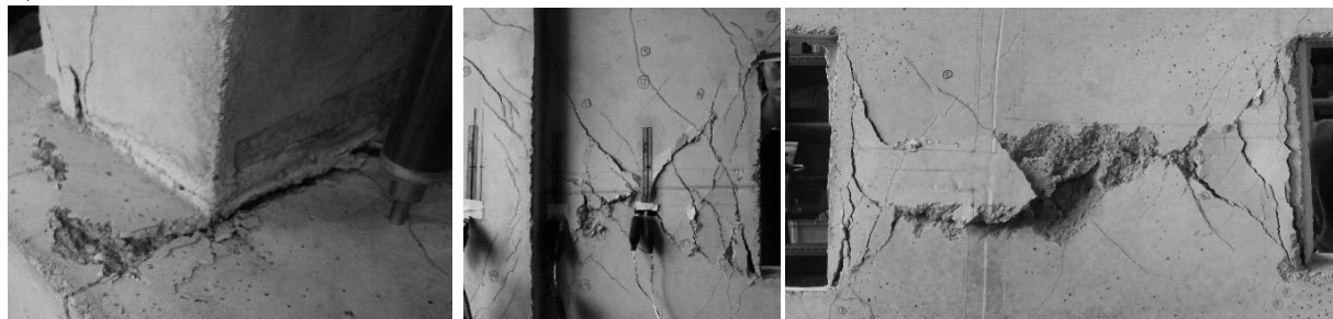
図-3 反曲点高さ比 1.5 の普通強度試験体の実験終了時のひび割れ状況図 (→:実験終了時の加力方向)
