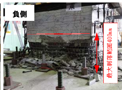
写真-1 試験体の破壊状況 ( 6\delta_y )
