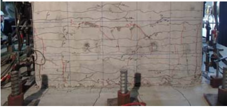
写真-4 計算上の終局点(2δ y 相当)における損傷状態
