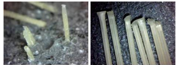
写真-5 PVAの破壊性状 (左:破断面における繊維, 右:繊維の原形)
