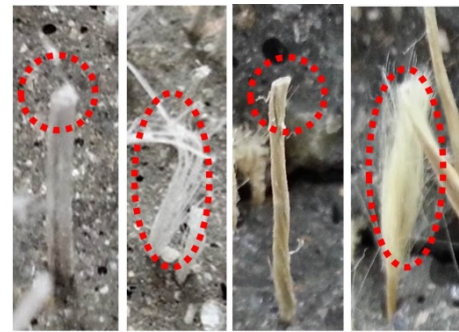
写真-4 繊維の引抜け型・破断型(左:PP, 右:AF)
