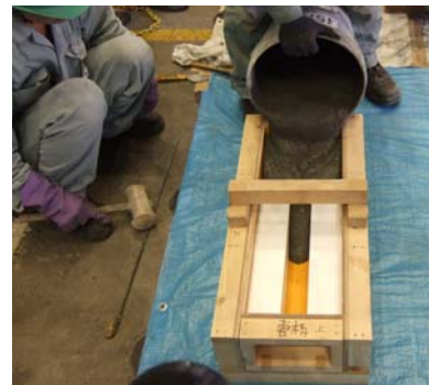
写真-2 直接引張試験試験体の打設状況
