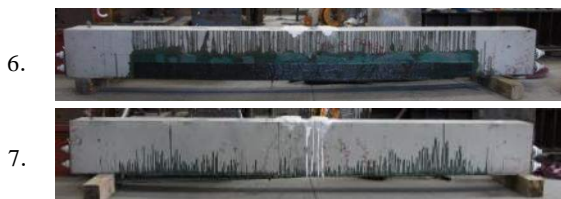
写真-2 荷重試験後の試験体 6 および 7
