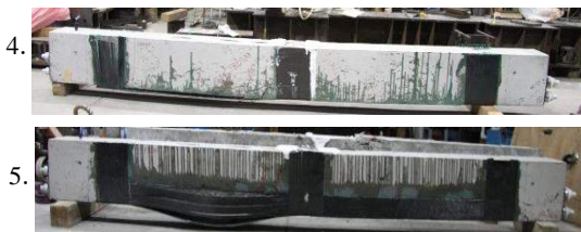
写真-1 荷重試験後の試験体 4 および 5
