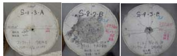
(a)付着破壊 (b)コーン破壊 (c)割裂破壊
