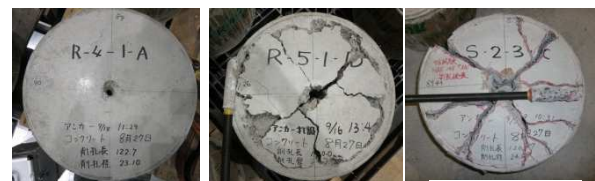
(a) 付着破壊 (b) コーン破壊 (c) 割裂破壊
