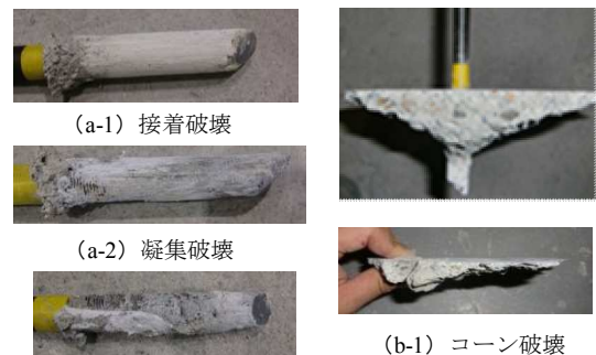
(a-1) 接着破壊 (a-2) 凝集破壊 (a-3) 接着・凝集破壊 (b-1) コーン破壊
