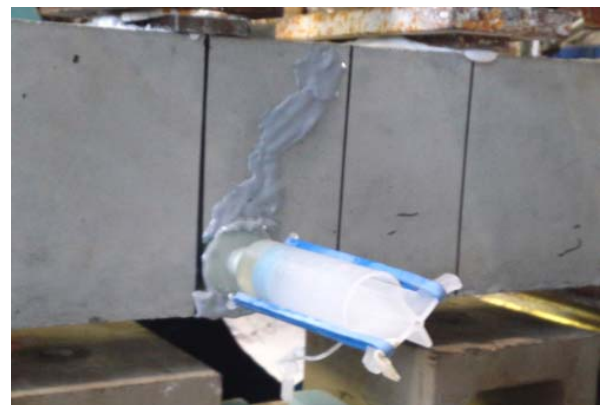
写真-1 ひび割れ注入補修の様子 (MB-90-50)
