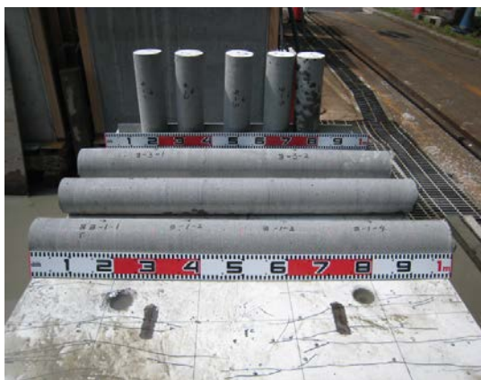
写真－4 試験体からのコア採取状況
