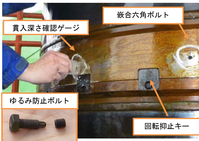
写真－1 六角ボルト貫入深さ確認ゲージ
