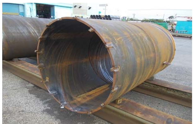
写真－5 杭先端ビット付鋼管
