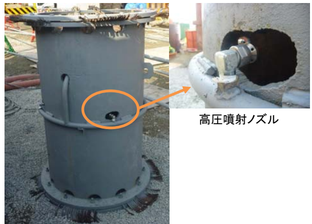
写真－3 高圧洗浄ノズルを用いた鋼管内面清掃機
