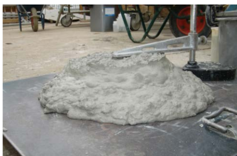
写真-2 スランプ試験（受入時）
