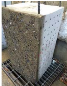
図-4 表層部を劣化させた角柱供試体の概観
