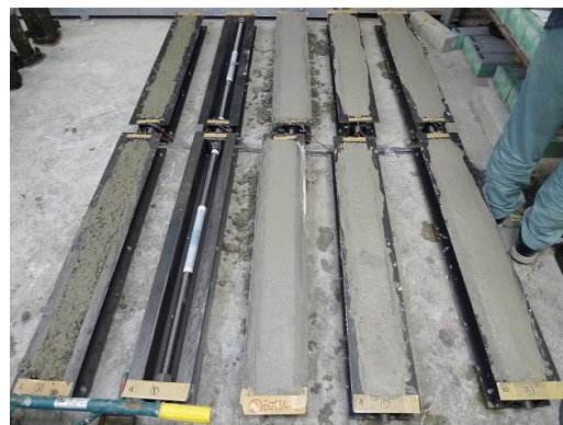
写真-1 拘束ひび割れ試験体の打込み状況
