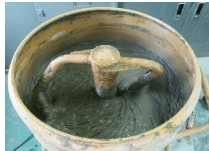
図-4 パン形強制練混ぜミキサと練混ぜ後の状況
