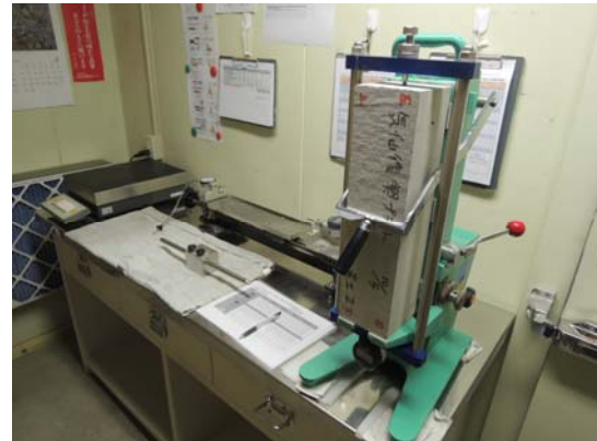
写真-1 縦型測定器による乾燥収縮率の測定
