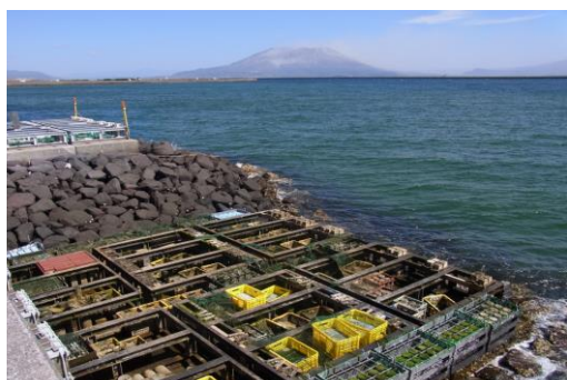
写真-1 海洋暴露試験場の様子(写真手前が干満帯)
