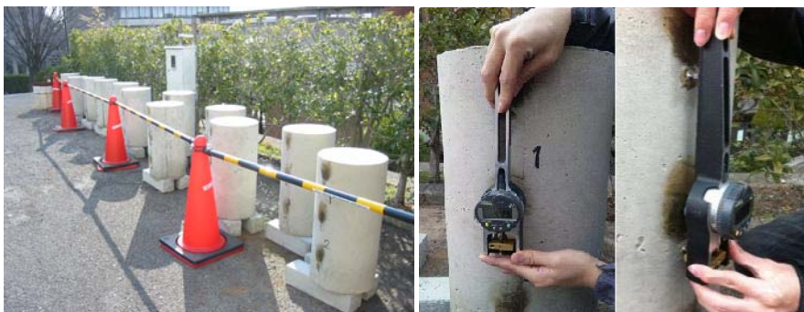
写真-1 コンクリート供試体の屋外暴露状況および測定状況
