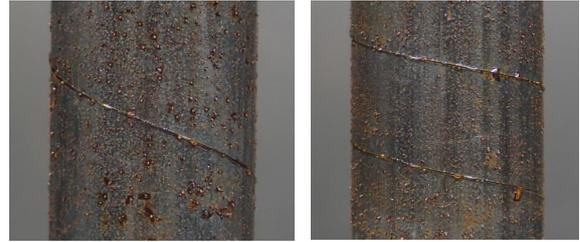
写真-1 腐食状況の一例 (左: 1-2, 右: 2-3)
