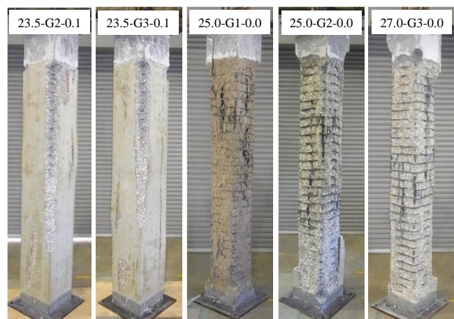
写真-1 実験後の試験体の状況
