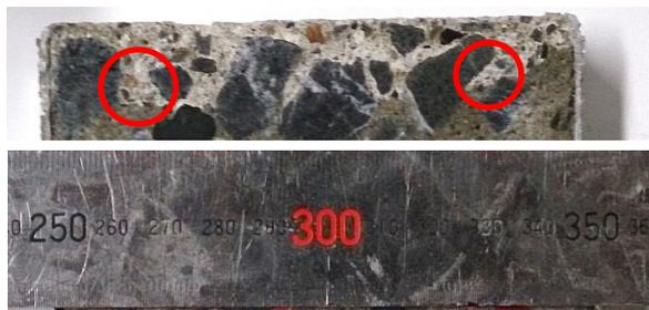
写真-3 塗布後試験体撥水層
