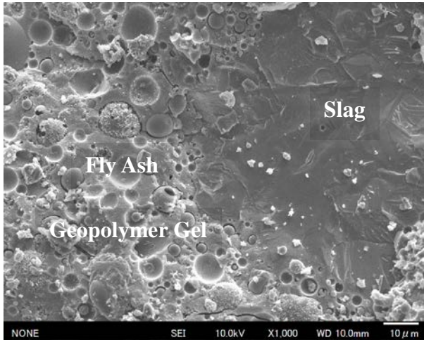
写真 - 4 35%塩酸浸漬前における電気炉酸化スラグ使用ジオポリマーモルタルの微細構造写真 (×1000)
