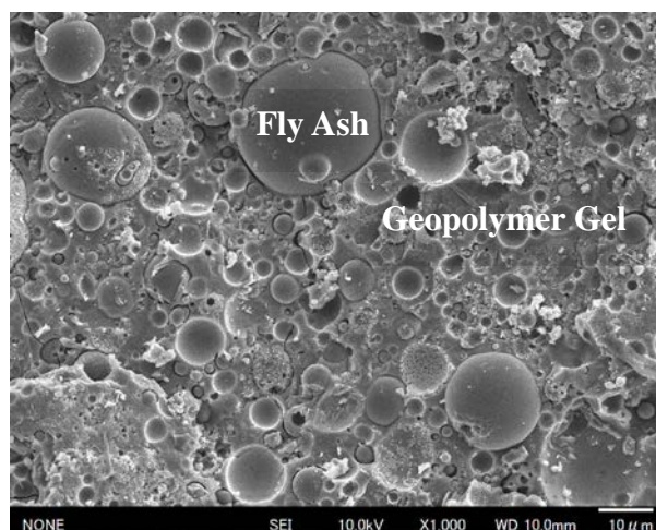
写真 - 2 35%塩酸浸漬前における珪砂使用ジオポリマーモルタルの微細構造写真 (×1000)
