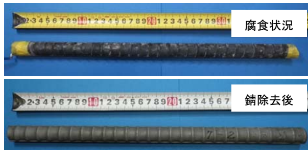
図-5 鉄筋の腐食状況（試番C1、NaCl添加）
