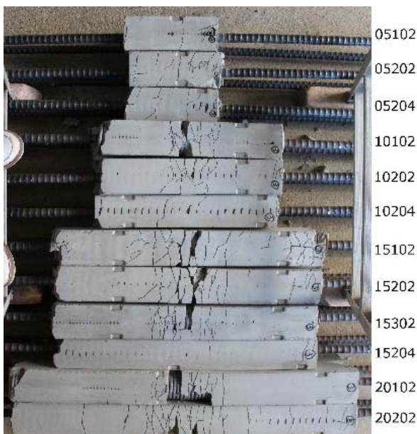
写真-1 破壊状況の例
