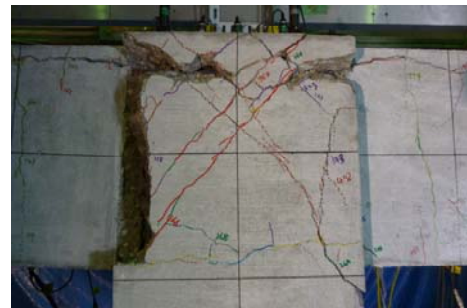
写真-1 試験体 T-3 接合部の最終破壊様子
