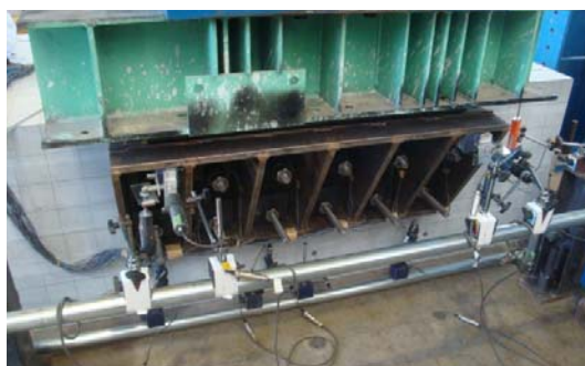
図-5 落橋防止装置の取付けおよび荷重状況
