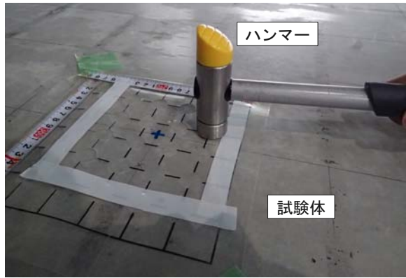
写真-7 機械インピーダンスに基づく方法 7)
