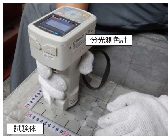
写真-4 分光測色計による色彩測定の様相 8)
