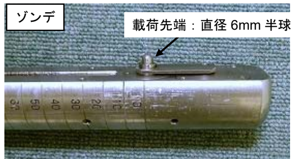
写真-8 孔内局部载荷試験の概要 10)
