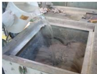
写真-1 強制二軸ミキサでの練混ぜ状況
