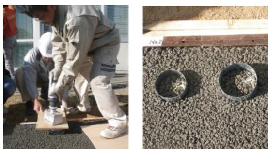
(a) 型枠振動機による鋼管の打ち込み (b) フレッシュ POC に打ち込まれた鋼管
