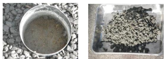
(c) 鋼管内部の試料の採取後 (d) 採取されたフレッシュ POC
