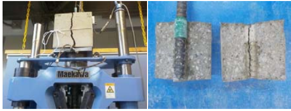
写真-1 JSTM C 2101 試験状況 (D41 の場合)
