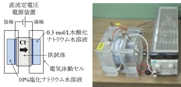
図-1 電気泳動セルと通電時の状況の例
