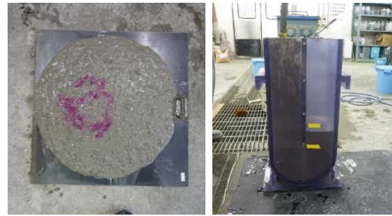
タッピング試験 間隙通過試験 写真-1 フレッシュコンクリートの試験状況
