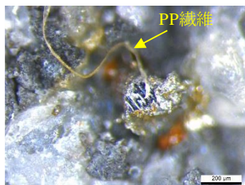
(a) 実体顕微鏡像(180°C加熱養生)
