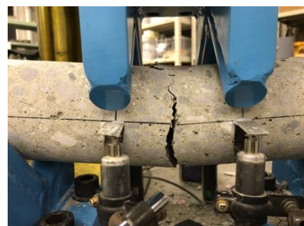
写真-4 コア供試体を用いた曲げタフネス試験状況
