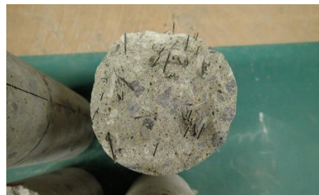
写真-6 試験後の供試体破断面
