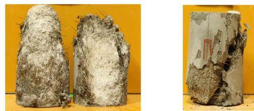
(a)分裂した供試体 (b)分裂しなかった供試体
