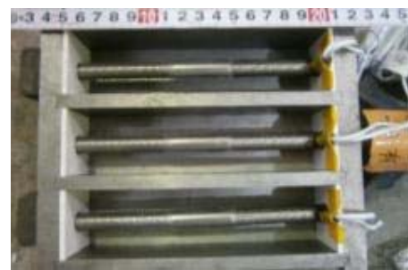
写真-1 モルタル供試体型枠の外観
