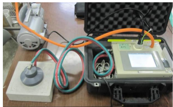
写真-4 表面透気試験状況
