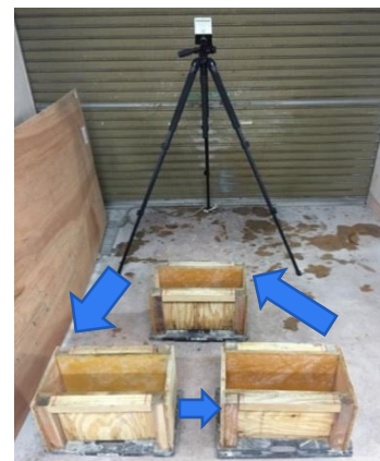
図-2 XYZカメラによる打込み面の撮影
